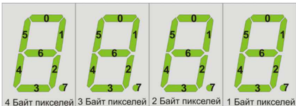
Схема раскладки битов (0-младший) по сегментам индикаторов
