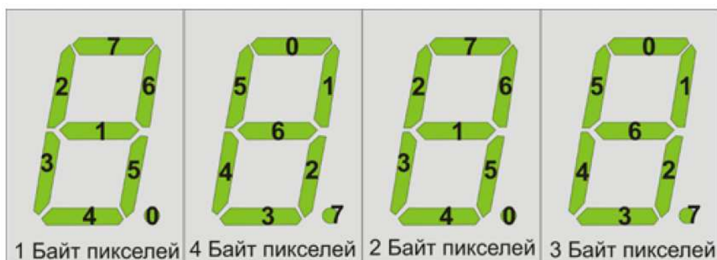
Схема раскладки битов (0-младший) по сегментам индикаторов
